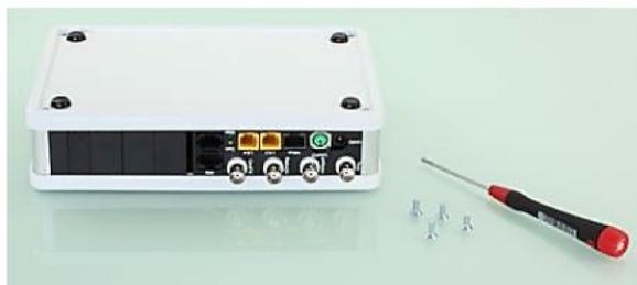
Переверните ProfiLux 4/4e вверх дном и осторожно ослабьте 4 шестигранных винта в 4 углах нижней пластины корпуса. Выверните винты и снова переверните корпус вместе с нижней пластиной.
