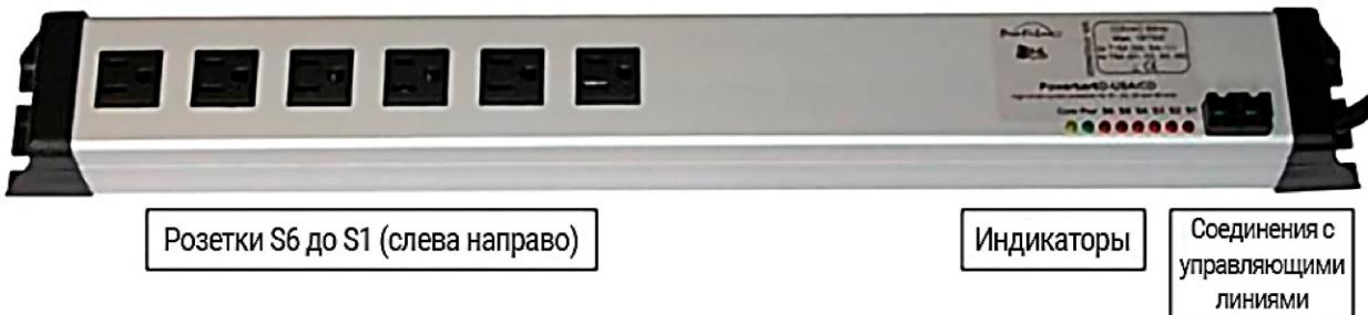
Цифровая силовая панель Powerbar 6D оснащена собственным микропроцессором и совместима с шиной (до четырёх Powerbar 6D может быть соединено последовательно).
