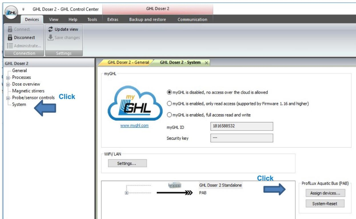
Дозатор Stand-Alone выполняет поиск всех устройств, подключенных к шине PAB, а затем отображает серийный номер найденных устройств. Затем выберите серийные номера **всех** устройств, которые должны быть назначены этому Stand-Alone дозатору, и подтвердите нажатием кнопки OK.
