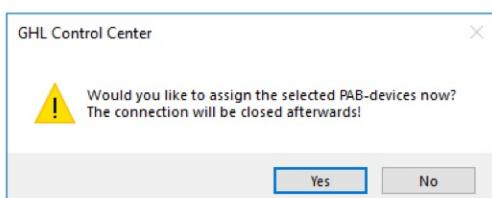
Чтобы завершить назначение устройств, соединение дозатора должно быть отключено от GCC. Подтвердите разделение с помощью кнопки «Да» («Yes»).
