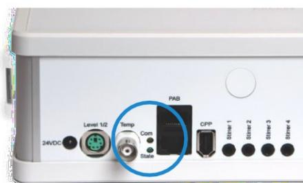
На задней панели GHL Doser 2.1 рядом с подключением датчика температуры расположены еще два светодиода, которые предоставляют информацию о состоянии подключения РАВ и состоянии связи РАВ.
