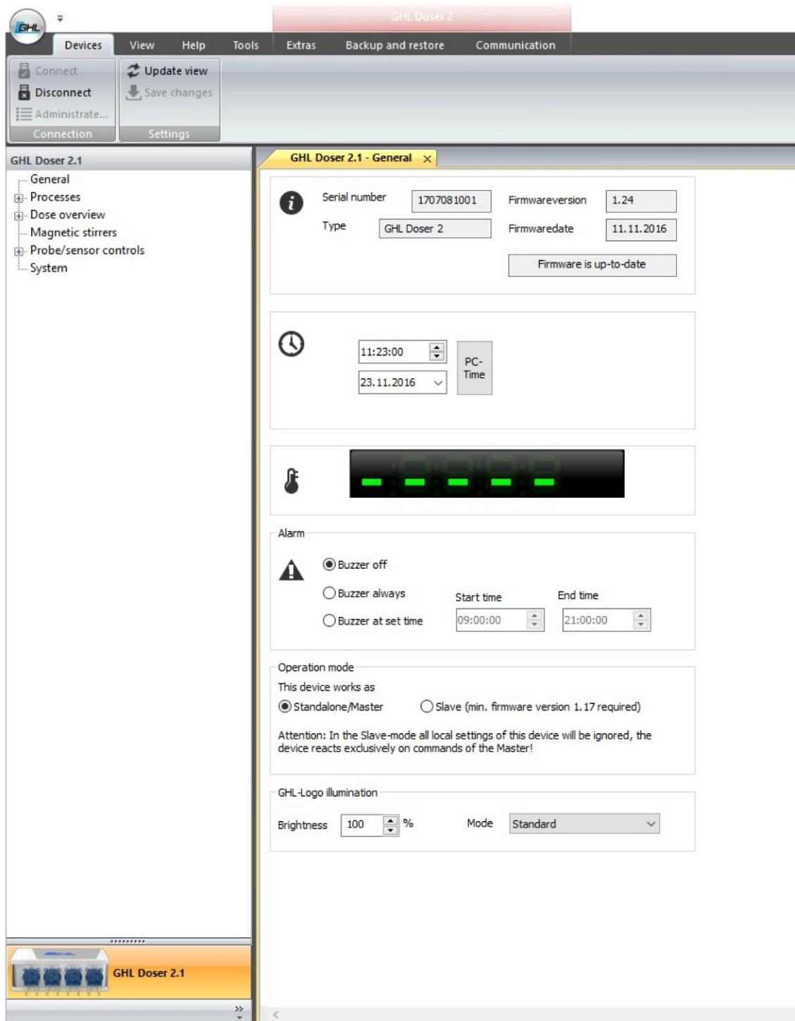
Соединение можно отключить, нажав кнопку «Отключить» («Disconnect») на верхней панели ленты.
