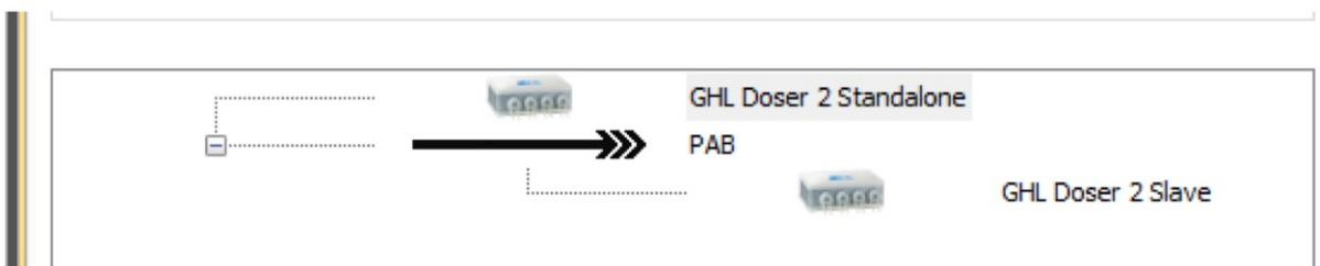
Подчиненный (*Slave*) дозатор был добавлен к Дозатору *GHL Doser 2.1*. В дополнение к 4 насосам Stand-Alone дозатора теперь доступны дополнительные насосы недавно назначенных Подчиненных (*Slave*) дозаторов.
