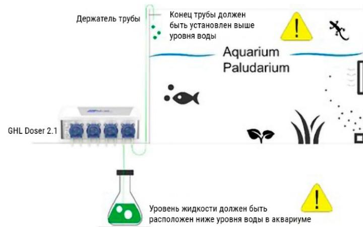
Для подключения дозирующего устройства к дозирующими контейнерам необходимо удлинить перистальтические трубы дозирующих насосов. Выберите трубку, подходящую для вашего применения, и присоедините ее к трубке дозирующего насоса с помощью прилагаемых трубчатых насадок. Избегайте растягивающей нагрузки. Трубчатые насадки подходят для труб с внутренним диаметром 2 и 4 мм.
