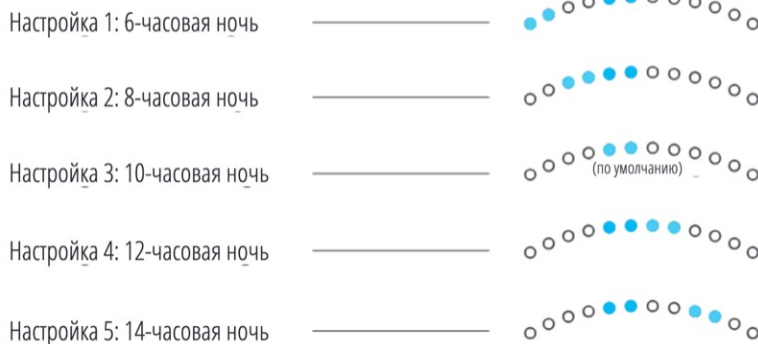
Драйвер показан здесь в конфигурационном режиме настройки времени ночного режима, показывая, что он настроен на 6-часовую ночь, а настройка по-умолчанию — это 10-часовая ночь.
